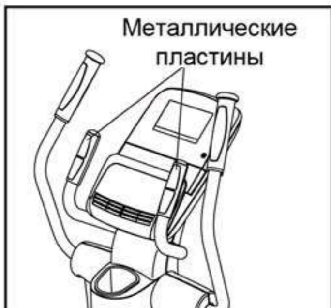
Когда компьютер определит ваш пульс, на дисплее появится мигающий символ сердца. Каждый удар соответствует частоте ваших сердечных сокращений. После одного или двух сильных ударов на дисплее отобразится значение частоты пульса. Для того чтобы произвести более точное определение частоты сердечных сокращений, удерживайте пластины около 15 секунд.
